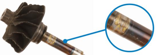
Verfärbung am Radiallagerdurchmesser der Läuferwelle
