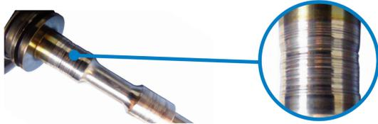
Riefen am Radiallagerdurchmesser der Läuferwelle
