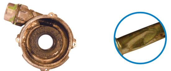
Verengungen oder Beschädigung am Ölablaufschauch und Anzeichen von Ölaustritt am Verdichter
